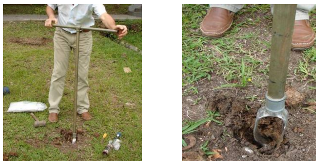
Figura 12 – Uso do trado holandês para coleta de amostras de solo a granel
