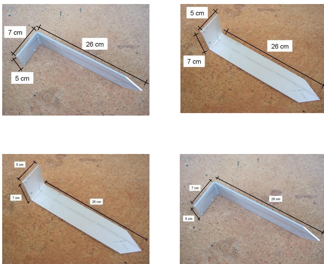
Figura 1: Especificações da barra de alumínio
