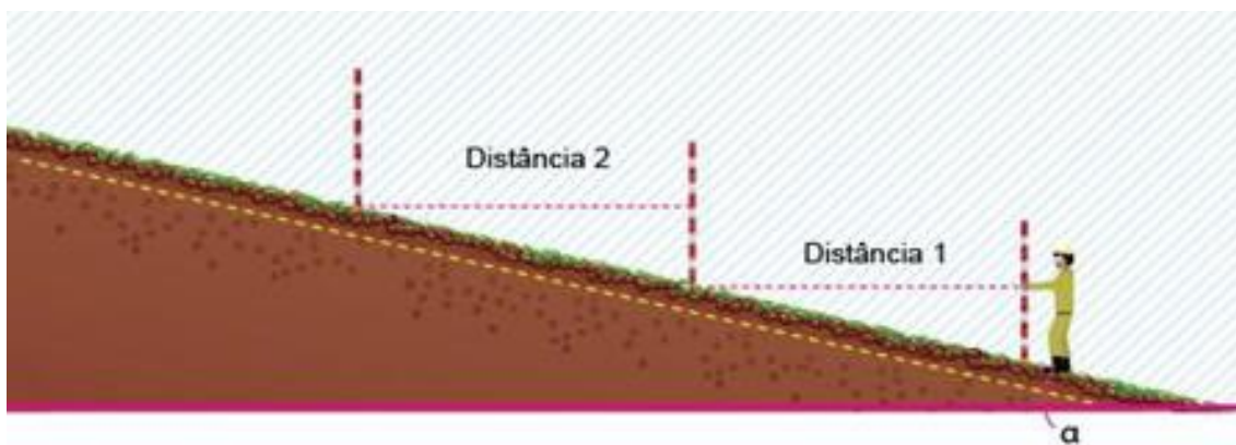
Figura 20a: Correção da declividade na medição de distâncias
