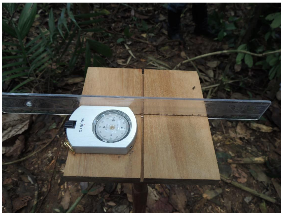
Figura 6: Bússola apoiada sobre a cruzeta no ponto central da unidade amostral.
