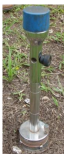
Figura 16 - Exemplo de trado para coleta de amostra indeformada de solo.
