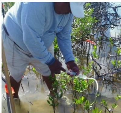
Es importante purgar el sifón, desechar la primera muestra hasta tener agua libre de sedimentos, es recomendable evitar extraer la muestra con burbujas de aire y una vez obtenida la muestra se de paso a la medición para evitar perturbación de la muestra.
