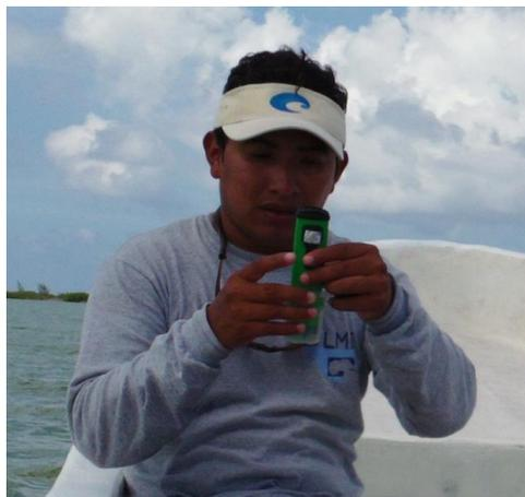
Figura 10.2. Toma de muestras de agua intersticial de suelo en los manglares y la medición del potencial redox y pH con el tester portátil de ORP/pH.
