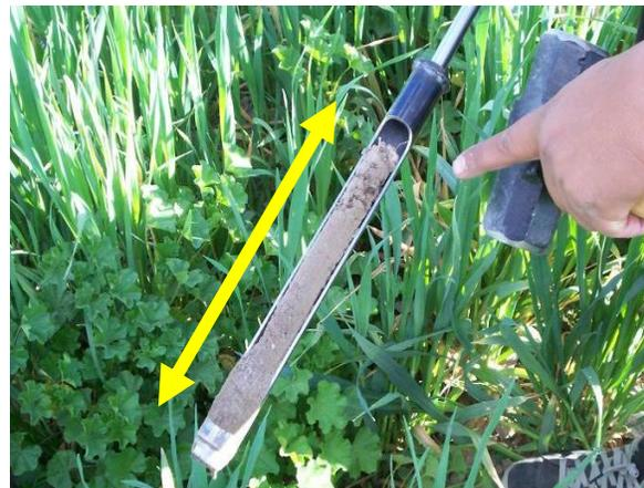
*Figura 8.10. Registro del espesor real de la muestra.*
