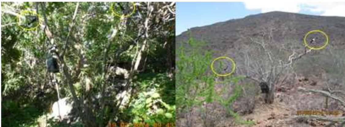
*Figura 5.11 Ejemplo de registro fotográfico de la toma abierta de la grabadora y la posición de los micrófonos (círculos amarillos).*
