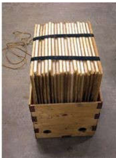
Figura 29d. Secadora de ejemplares de herbario que antes se usaban con focos eléctricos para producir calor. Como los focos de ahorro de hoy producen poco calor, ahora se usan “resistencias eléctricas” que incluso son más eficientes.
