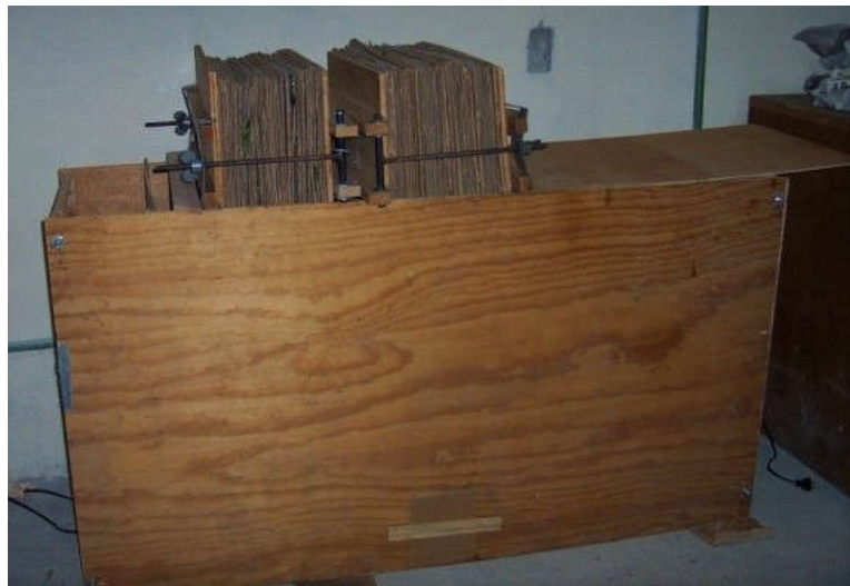
Figura 29b. Secadora de ejemplares de herbario con focos eléctricos o con estufa de gas como fuente de calor. Las secadoras de campo son desarmables.
