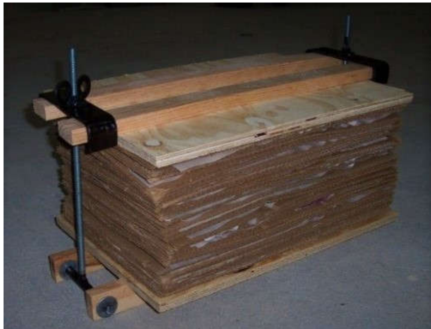
Figura 28. Un mecanismo para prensar con tornillos es menos común, pero muy efectivo.
